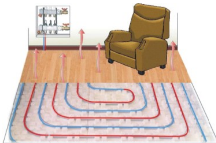
Ilustración 25. Circuito de suelo radiante. Fuente http://www.ecoinnova.com/suelo-radiante/funcionamiento-del-suelo-radiante/
