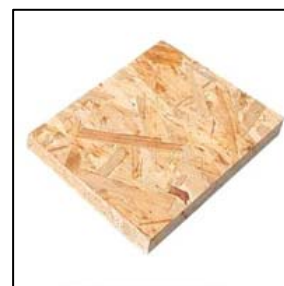
Ilustración 17. Tablero OSB, a base de conífera descortezada.
