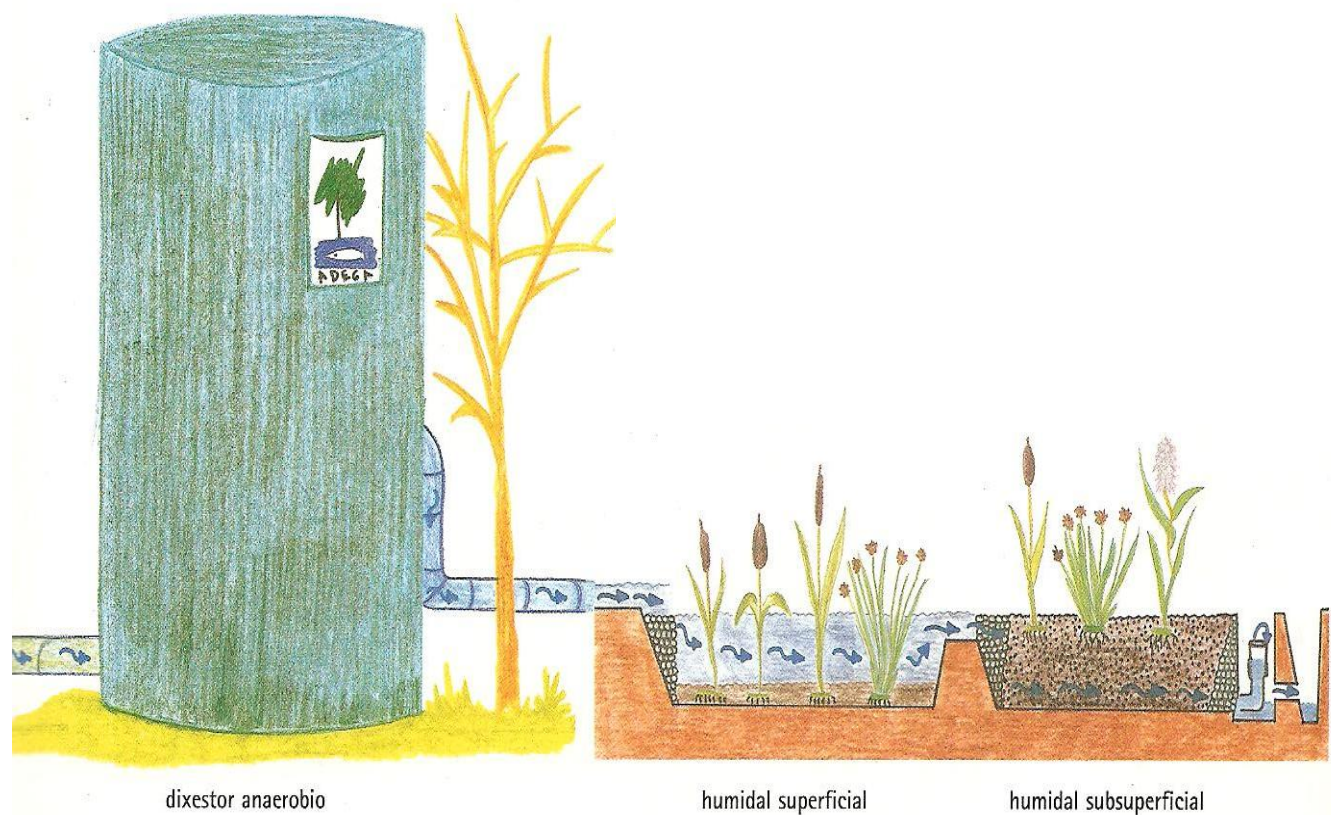
Esquema dun sistema de depuración natural e de baixo custo. Proxecto tecnolóxico-educativo da Asociación ADEGA en colaboración co Grupo de Investigación de Enxeñaría Química Ambiental da UDC situado na Silvouta, Santiago de Compostela.
