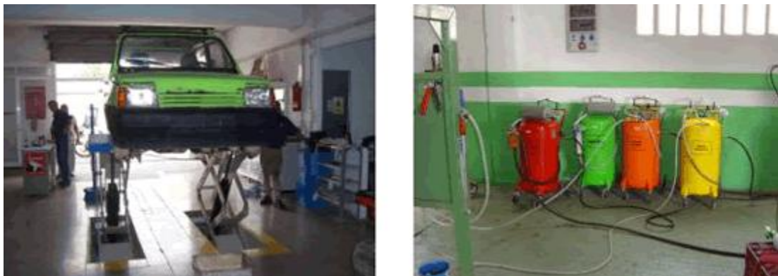
Figura 32. Zona de descontaminación en un CAT y equipos automáticos de descontaminación. Fuente SIGRAUTO
