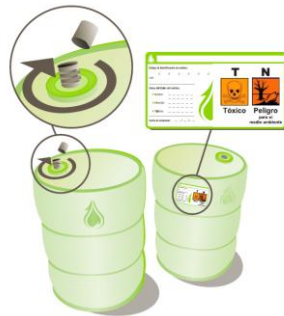
Figura 38 Bidones de recogida de aceites usados debidamente etiquetados. Fuente: SIGAUS
