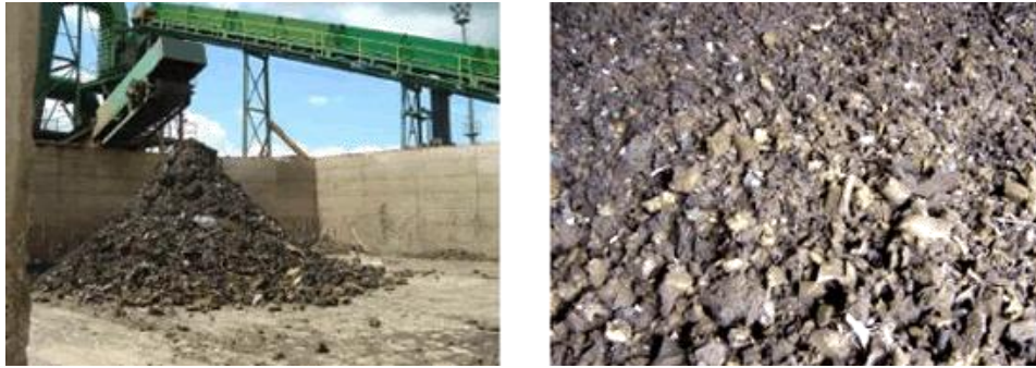
Figura 36 Salida de Residuo ligero en una fragmentadora y detalle.
