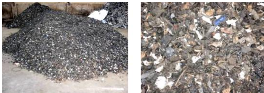
Figura 37 Residuo pesado de fragmentadora sin metales y detalle.
