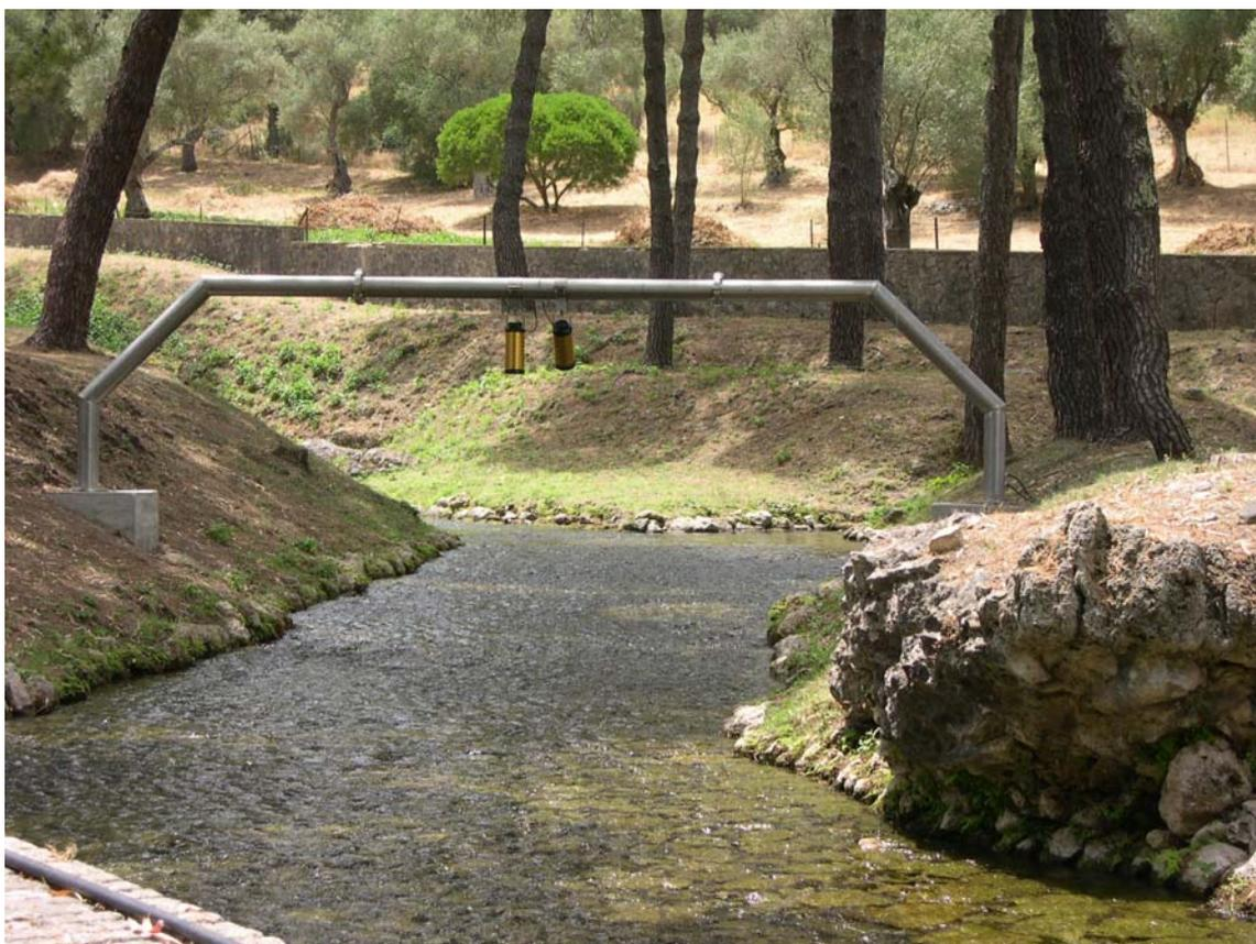
**Figura 8. Control de las salidas del manantial del Tempul (Jerez, Cádiz), mediante un sistema de radar**
