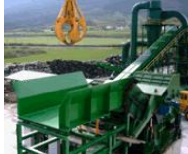
Figura 26 bandeja basculante. Fuente: FER
