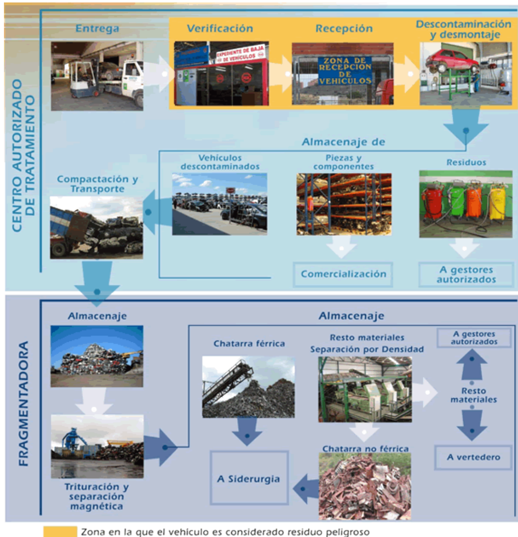
Figura 15 Esquema de los procesos que sigue un VFU. Fuente: SIGRAUTO
