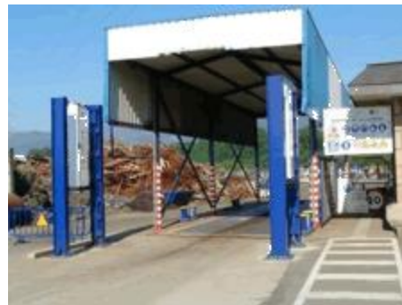
Figura 23 Pórtico vigilancia radiológica y báscula. Fuente: FER
