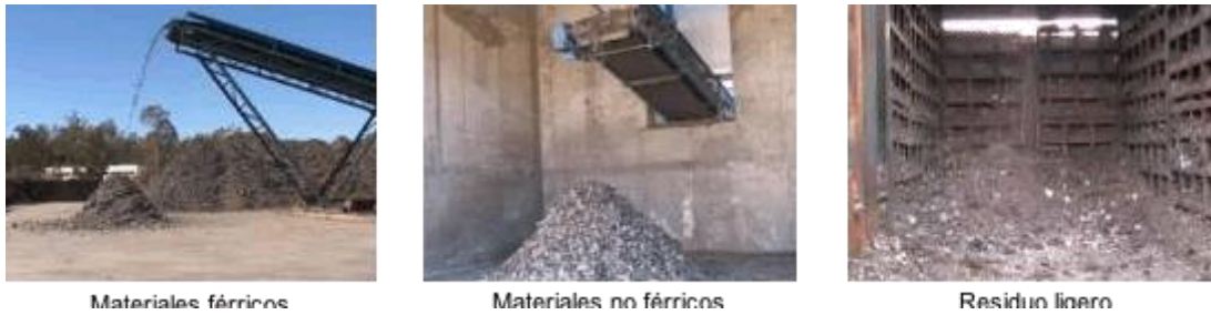
Figura 34 Materiales férricos, materiales no férricos y residuo ligero.
