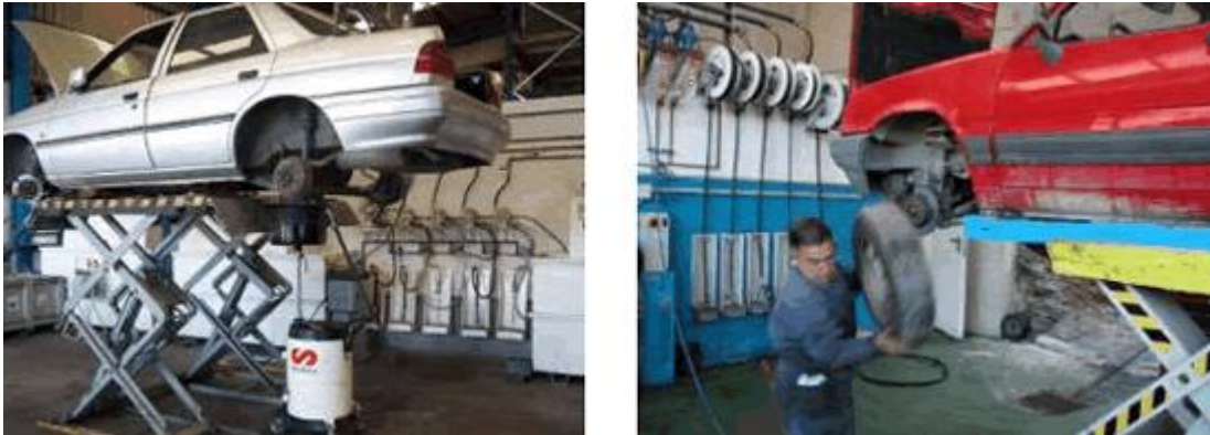
Figura 18 Zona de Descontaminación de VFUs en CATs. Fuente: SIGRAUTO
