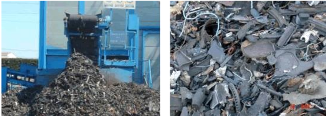
Figura 31 Salida de las gomas con metales y detalle. Fuente: SIGRAUTO
