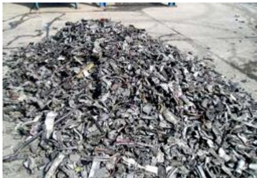
Figura 43 Metales no ferricos entre 40 y 80 mm. Fuente: SIGRAUTO
