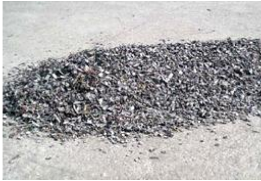
Figura 45 Metales no fèrricos entre 20 y 40 mm. Fuente: SIGRAUTO
