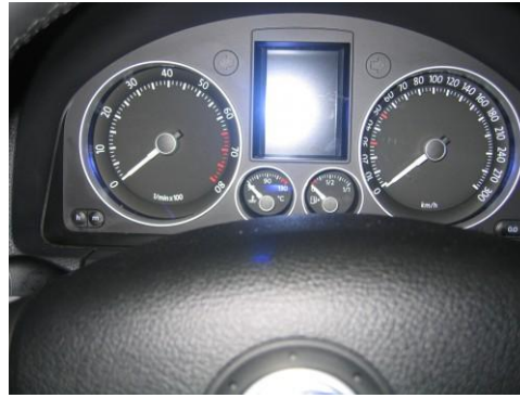
Figura 68 Panel de instrumentos realizado con PMMA. Fuente: Volkswagen
