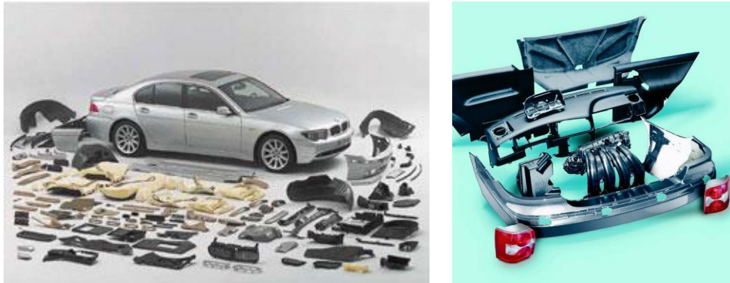
Figura 66 Componentes realizados con plásticos. Fuente: BMW
