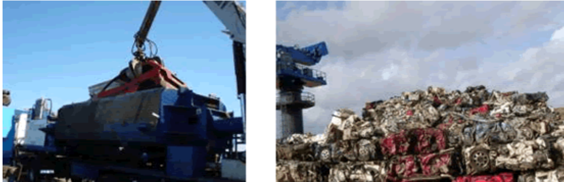
Figura 20 Compactación de VFUs y almacenamiento en Fragmentadora. Fuente: SIGRAUTO
