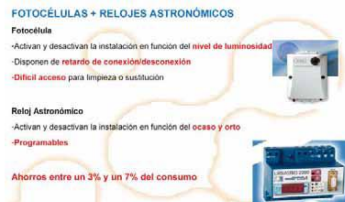
Figura 20 .Fotocélula y reloj astronómico
